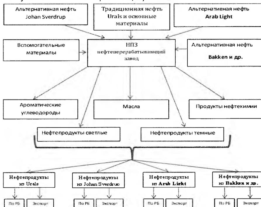
**Рисунок 2. – Схема совместной переработки традиционной нефти Urals и альтернативных сортов нефти, реализации продукции НПЗ**
