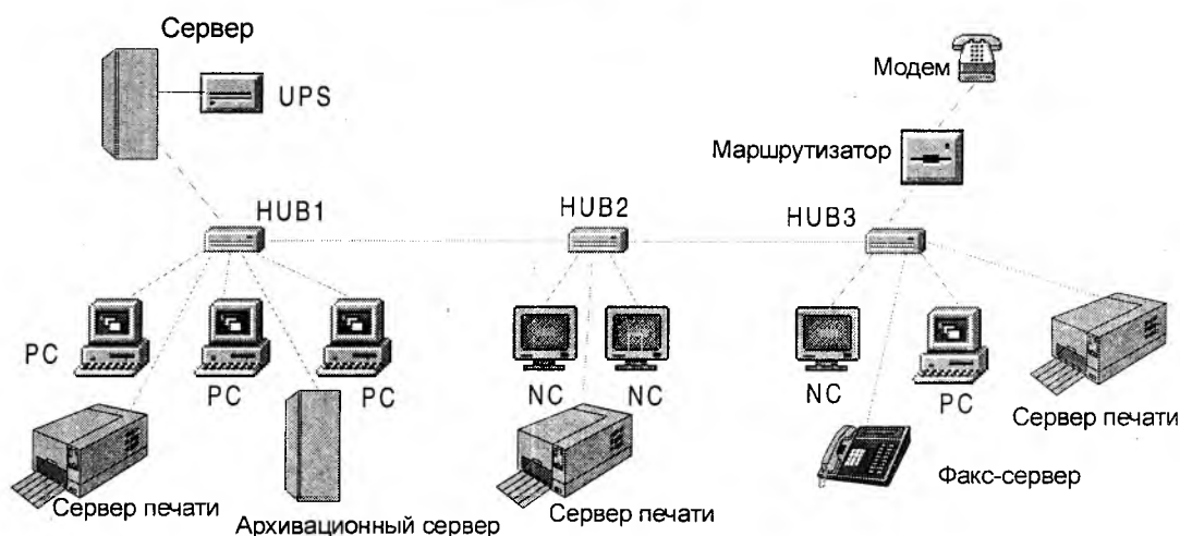
Рис. 1 Двухуровневая ЛВС шинно-звездной топологии
