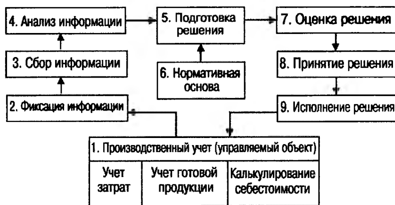
Рис. 2. Контур управления информационной системой производственного учета организации
