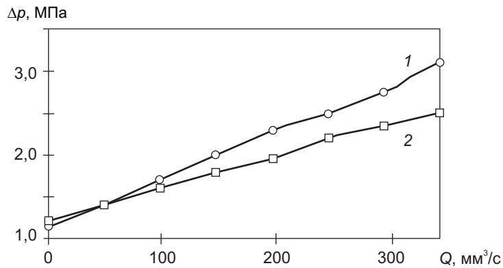
Зависимость перепада давления на капилляре  $\Delta p$  от расхода материала  $Q$  при истечении композиционного расплава через капилляр длиной, мм: 1 — 53,8; 2 — 30
