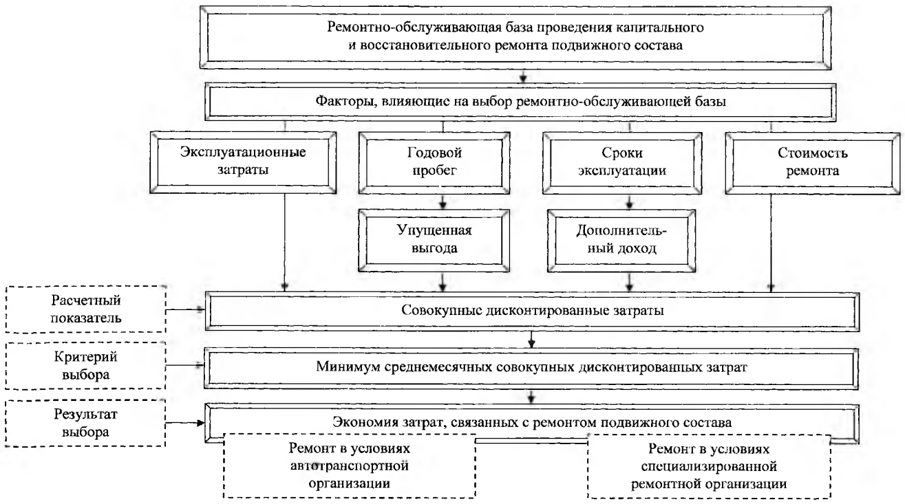
Рисунок 2 — Схема выбора ремонтно-обслуживающей базы для проведения капитального и восстановительного ремонта подвижного состава
