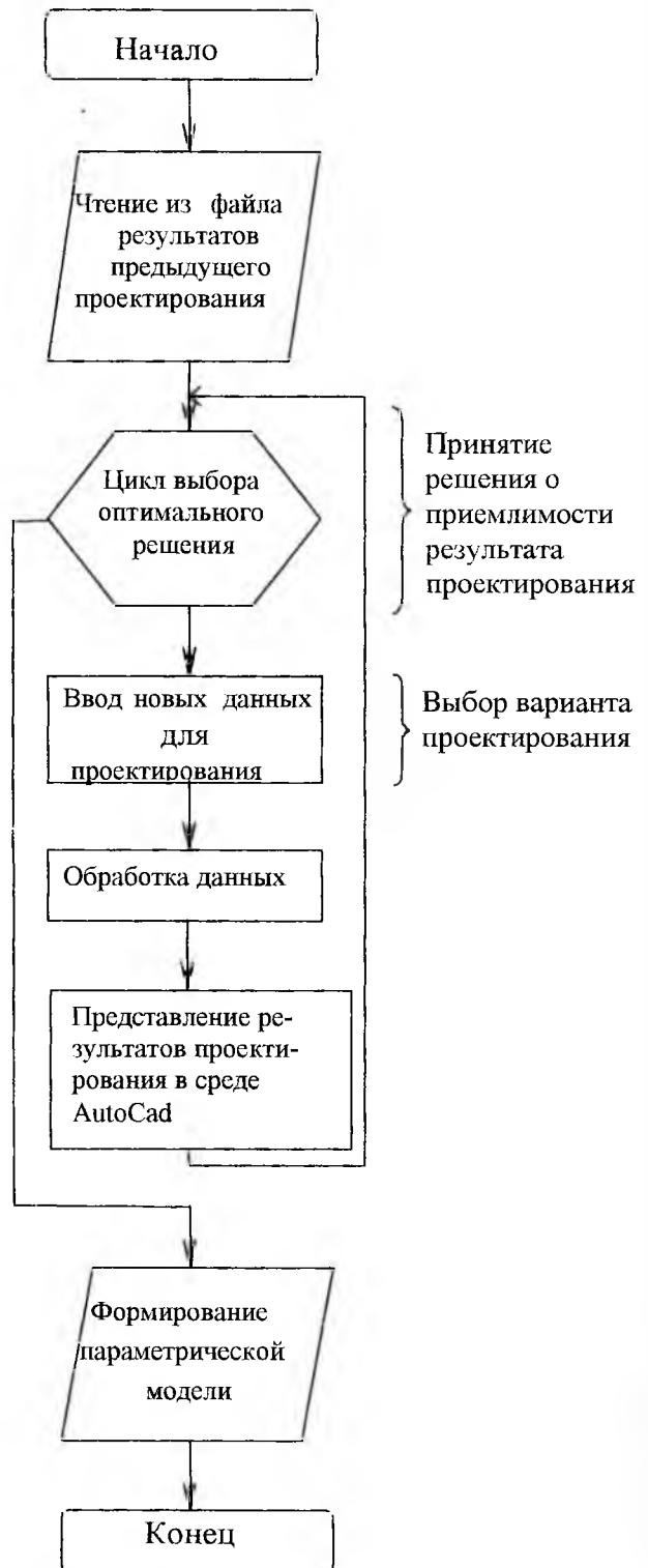
Рисунок 1. Унифицированный алгоритм работы конструкторской процедуры в ПК ФОРЛИТ
