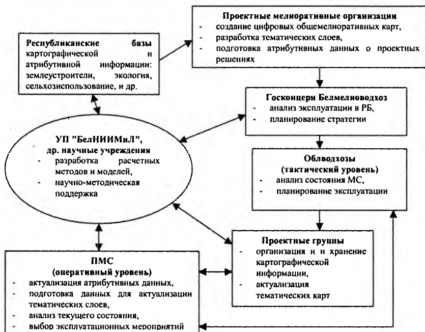
Рис. 1. Структурная схема геоинформационной поддержки эксплуатации МС
