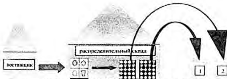
Рис. 1. Схема работы склада по технологии «pick-by-line»
