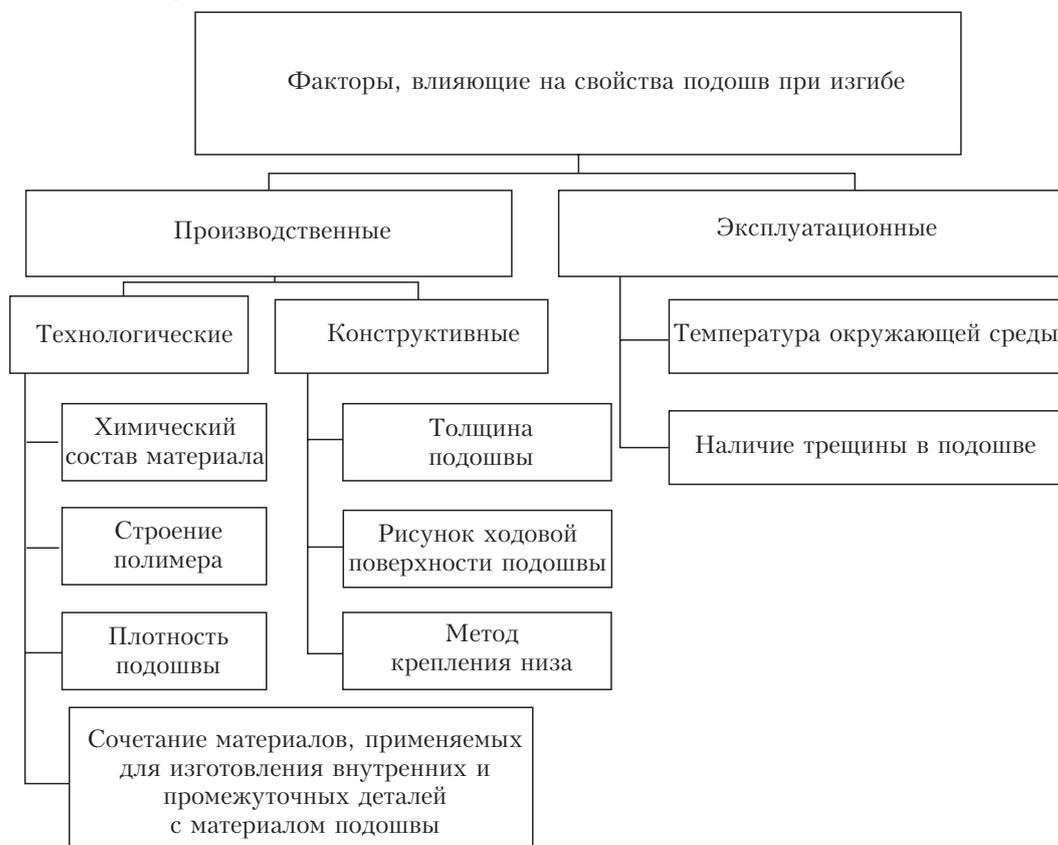
Рис. 1. Иерархическая классификация факторов, влияющих на свойства подошвенных материалов при изгибе
