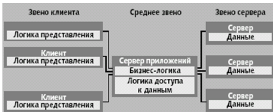
Рис. 2. Трехуровневая клиент-серверная архитектура
