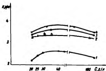
Рис. 2. Фиксация дисперсного синего полиэфирного и активного ярко-голубого красителя на ткани из полиэфирного и вискозного волокон: 1, 2 -- фиксация на вискозном волокне соответственно при 200 и 205^{\circ}\text{C} ; 3, 4 -- фиксация на полиэфирном волокне соответственно при 200 и 205^{\circ}\text{C} .
