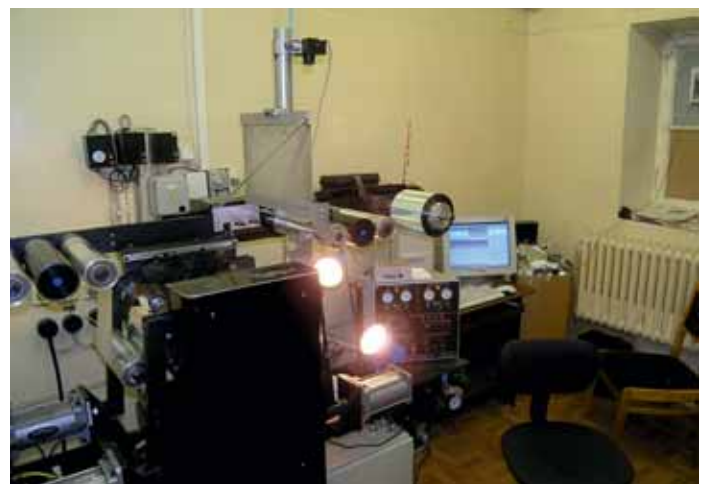
4 Система диагностики дифракционных характеристик рельефных голограмм в процессе производства
