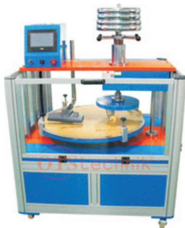
Прибор для испытания на истирание с применением кресла на колесиках
